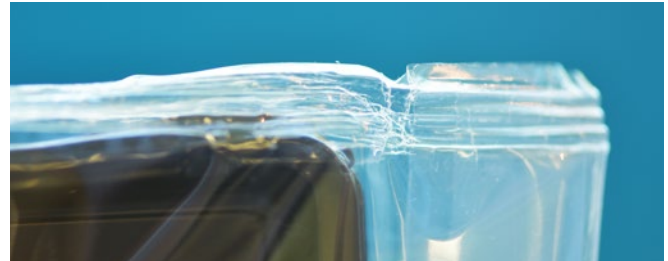
Verpakkingen met plooiën (boven) en schaalte in lasnaad (onder) uitgestoten door het SealScope™ systeem
