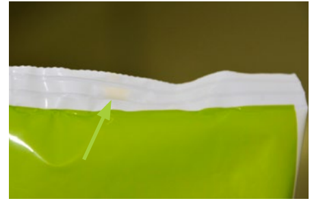
Käsestücke in einer Siegelnaht, die von SealScope® aussortiert wurde
